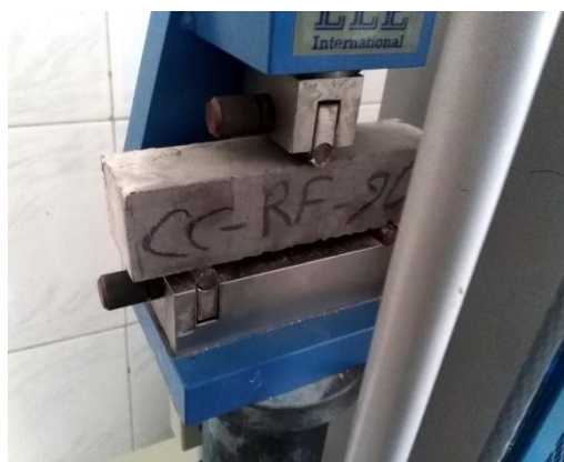
شکل ۳: آزمایش مقاومت خمشی تیر ساده با بارگذاری نقطه مرکزی.
