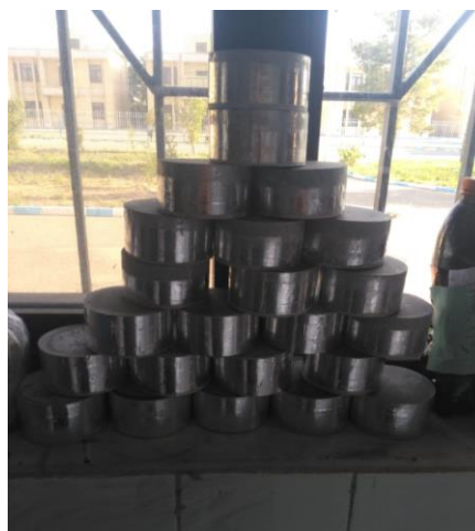
شکل ۴: آزمایش جذب موئینه: الف) عایق بندی نمونه ها ب) قرارگیری نمونه ها در دستگاه جذب موئینی.
