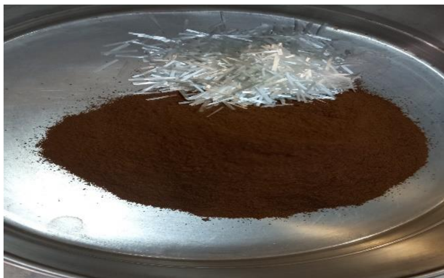
شکل ۲: مواد خام اولیه پودر لاتریت با الیاف شیشه.
