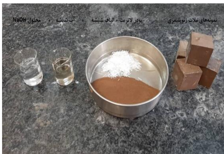
شکل ۳: فرآیند کلی ساخت نمونه‌های ملات ژئوپلیمری.
