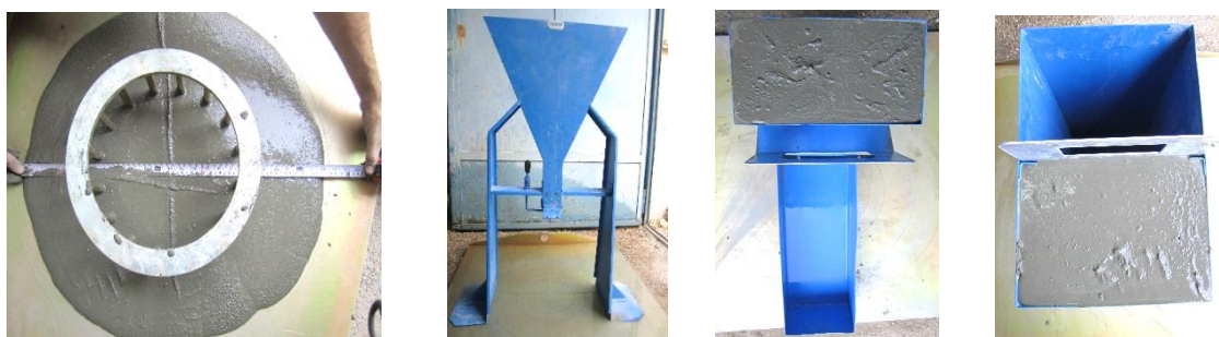
شکل ۵: آزمایش‌ها: (الف) جعبه U، (ب) جعبه L، (ج) قیف V، (د) حلقه J
