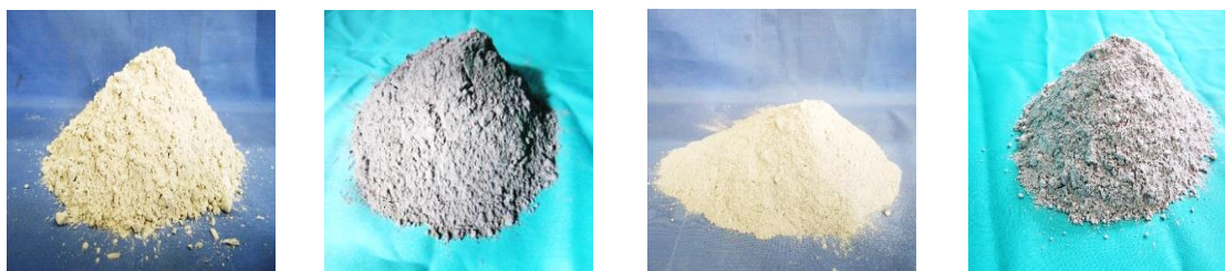
شکل ۲: تصویری از (الف) سیمان، (ب) خاکستر بادی، (ج) میکروسیلیس و (د) سرباره (مورد استفاده جایگزین سیمان)
