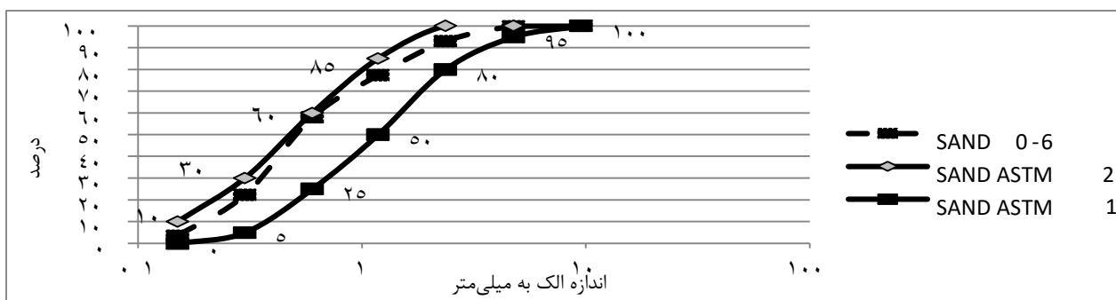
شکل ۱: نمودار دانه بندی ماسه مصرف شده بر اساس ASTM C۳۳ [۳۲]
