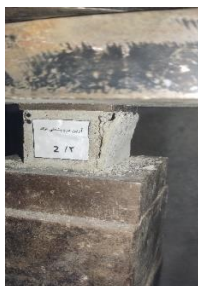
شکل ۴: نمونه ملات ژئوپلیمر حاوی کائولن و سرباره تحت آزمایش مقاومت فشاری
