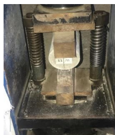
شکل ۶: نمونه استوانه‌ای تحت آزمایش کشش برزیلی
