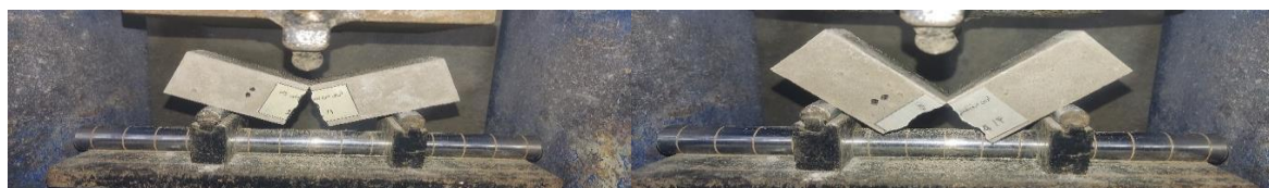
شکل ۵: مقاومت خمشی سه نقطه‌ای نمونه ملات ژئوپلیمر حاوی کائولن و سرباره
