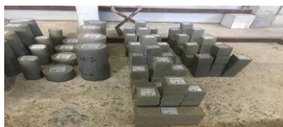
شکل ۳: نمونه ملات ژئوپلیمر ساخته شده از سرباره کوره آهنگدازی و کائولن
