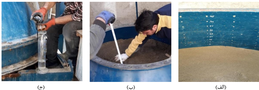
شکل ۹: روند ساخت و اشباع نمونه؛ (الف) کنترل ارتفاع؛ (ب) متراکم کردن؛ (ج) کنترل دبی خروجی برای اشباع کردن نمونه.
