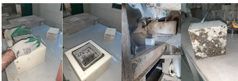
شکل ۱۰: برش و آماده‌سازی آزمون جهت آزمایش چرخه ذوب و یخبندان.
