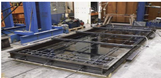
شکل ۲: قالب دال پیش‌تنیده پیش از بتن ریزی [۱۴]
