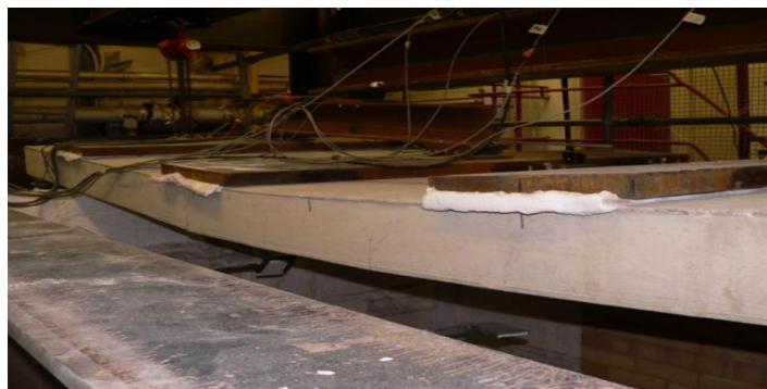
شکل ۹: تغییر شکل دال در مطالعه آزمایشگاهی نمونه TB2 [۱۴]
