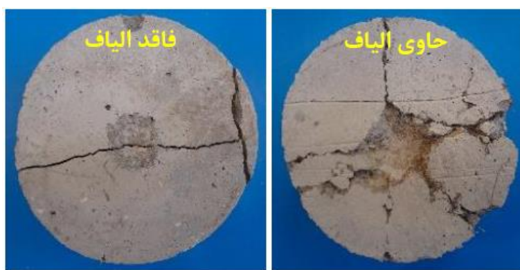
شکل ۹: تفاوت در نحوه گسیختگی نمونه‌های حاوی و فاقد الیاف در آزمایش ضربه وزنه افتان.
