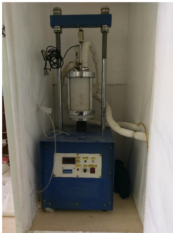
شکل ۴: تصویری از محیط آزمایشگاه و سلول سه‌محوری برای خاک‌های منجمد
