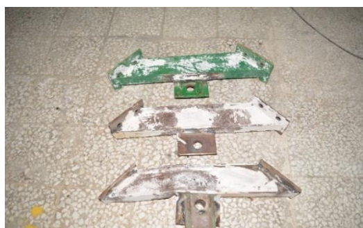
شکل ۱۵: جاری شدن جان و بال زانویی در نمونه های شماره ۱، ۲ و ۳
