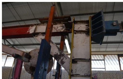
شکل ۱۲: تغییر شکل زانویی در نمونه شماره یک
