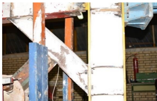
شکل ۱۴: تغییر شکل المان زانویی در نمونه شماره سه
