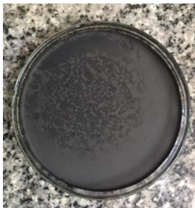
شکل ۲: تصویر از گرافن رسوب شده از محلول 5G/0.56S.
