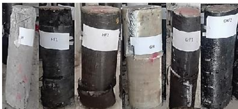
ب) ستون‌های ساخته شده از بتن پرمقاومت
