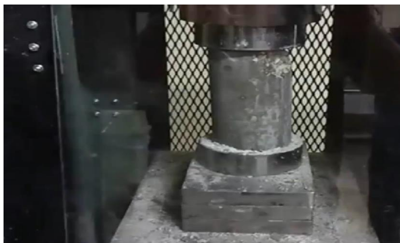
شکل ۱- نحوه آزمایش نمونه های بتنی با جک بارگذاری
