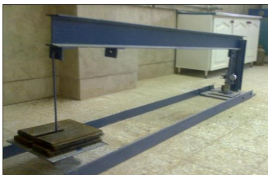
شکل ۴. دستگاه اهرم مکانیکی طراحی شده برای آزمایش خزش
