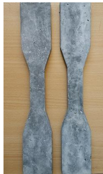
شکل 3: نمونه‌های استخوان سگ جهت انجام آزمایش کشش تک‌محوری [۲۱]
