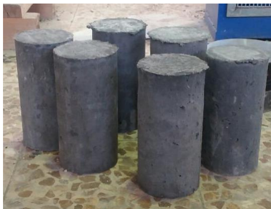
شکل 2: شش نمونه استوانه‌ای ECC با درصد الیاف 1.5% و 2% مطابق استاندارد ASTM C192 [۲۳]
