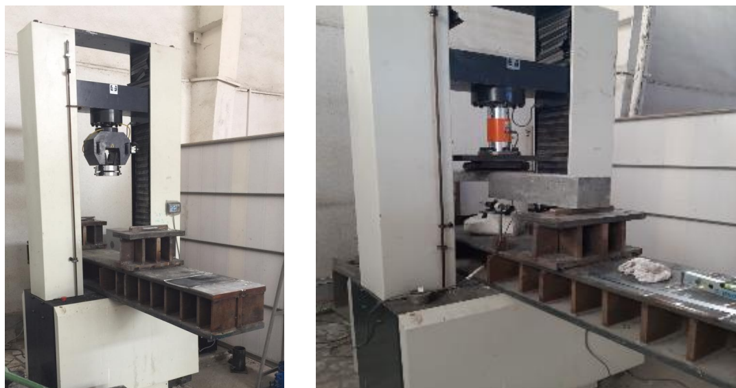
شکل 7: نحوه قراگیری نمونه‌ها در دستگاه اعمال بار جک
