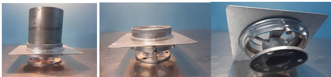
شکل ۵: زاویه ساز (نقاله مندرج) ساخته شده که مدل در تونل باد بر روی این صفحه نصب می‌شود
