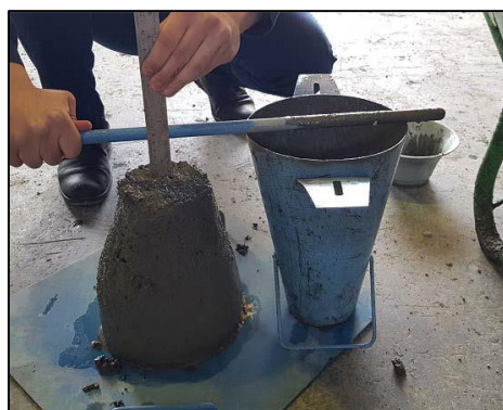
شکل ۳: آزمایش تعیین اسلامپ بتن تازه
