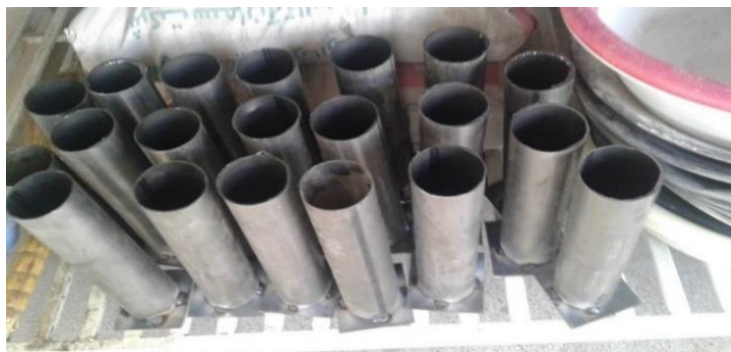
شکل ۲: نمونه‌های ساخته شده از لوله فولادی ۷۶×۱/۲۵
