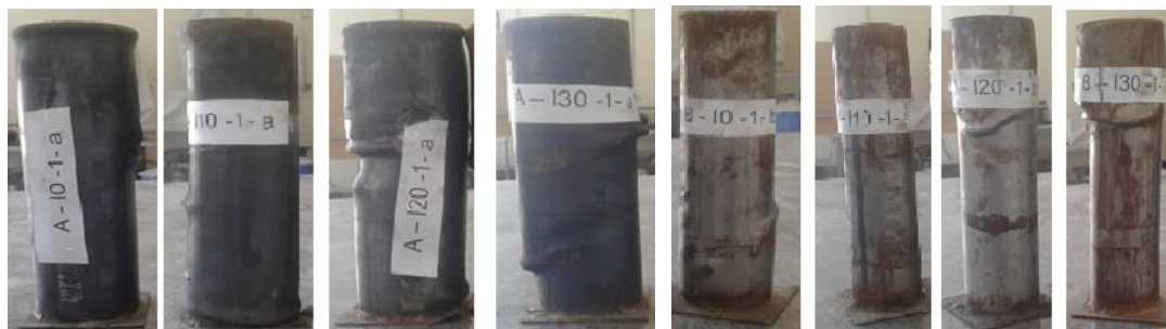
شکل ۱۸: شکل خرابی نمونه ها
