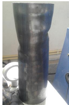
شکل ۸: نمودار بار-تغییر مکان و مودهای خرابی نمونه‌ها (الف) مقطع A، لوله ۸۸×۲، (ب) مقطع B، لوله ۷۶×۱/۲۵.
