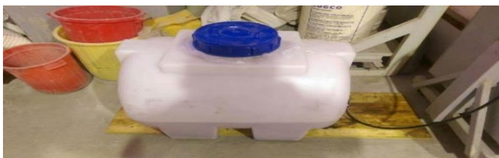
شکل ۱: مخزن حاوی آب و نمک ۵ درصد برای ایجاد محیط کلریدی
