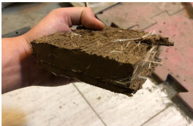
شکل ۱۱- نمونه خاک برش خورده در آزمایش برش مستقیم
