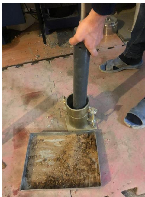
شکل ۵- آزمایش تراکم استاندارد جهت تعیین حداکثر دانسیته خشک و تعیین رطوبت بهینه
