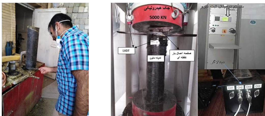
الف- جک بتن‌شکن و دیتالاگر ب- نحوه قرارگیری ستون بتنی در جک بتن‌شکن ج- اصلاح نمونه
