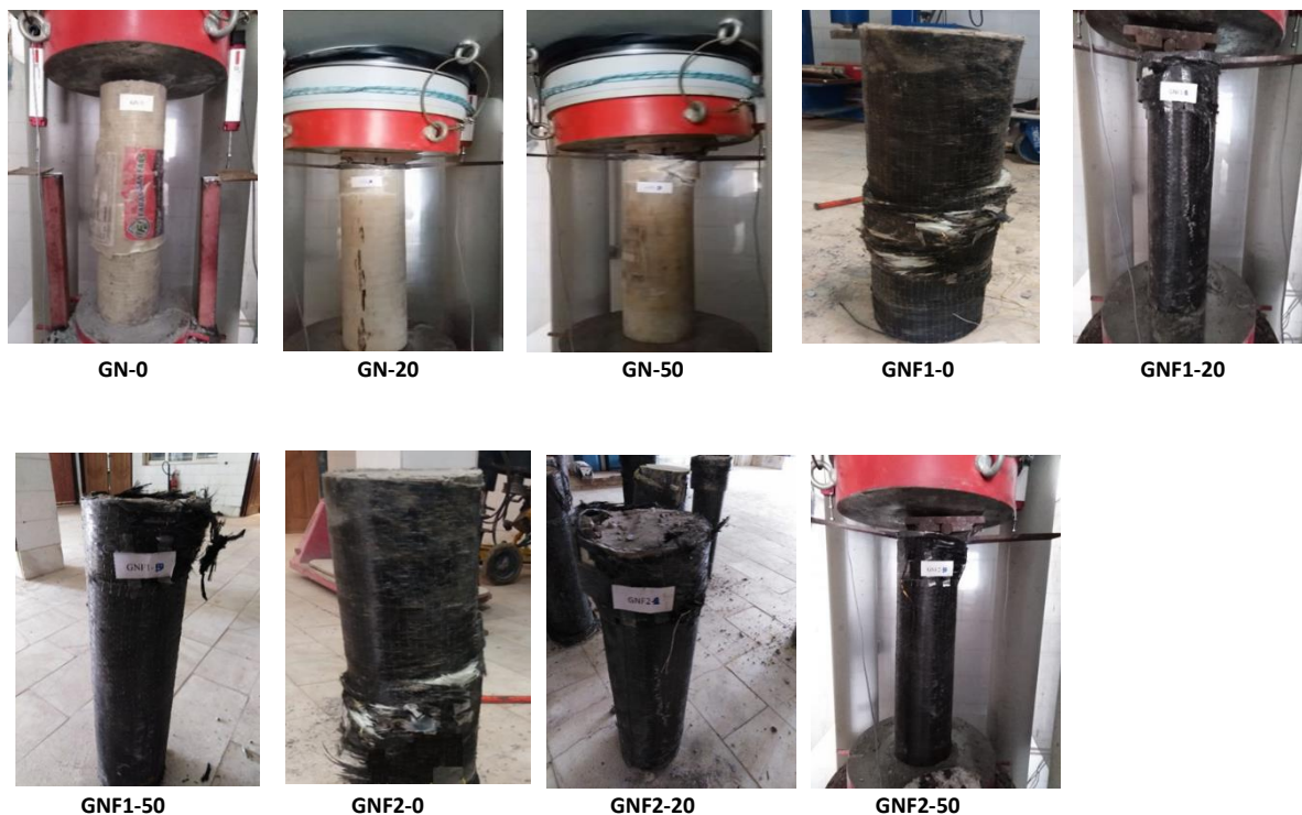
شکل ۱۱- نمایش گسیختگی نهایی ستون‌های دارای غلاف GRP پس از بارگذاری
