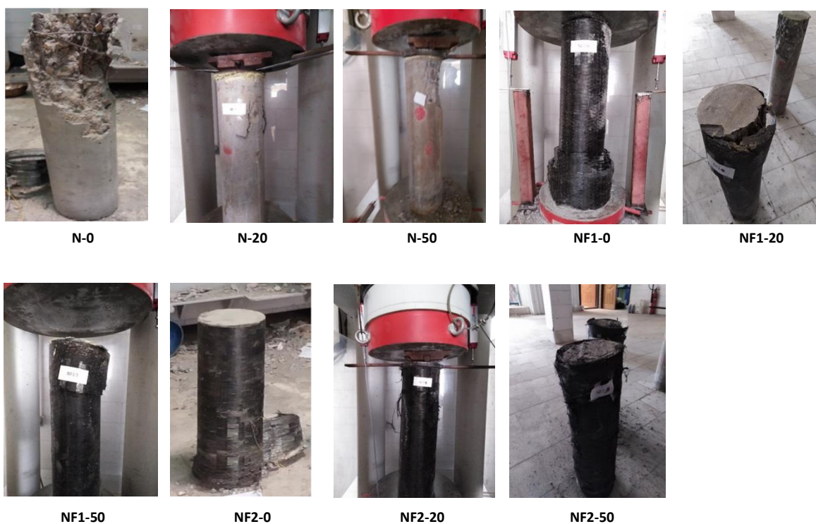
شکل ۱۰- نمایش گسیختگی نهایی ستون‌های فاقد غلاف GRP پس از بارگذاری
