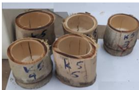
شکل ۶- نمایی از نمونه‌ها پس از انجام تست فشاری
