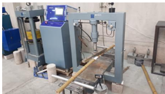
شکل ۱۰- دستگاه تست خمش در راستای فیبر
