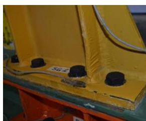
شکل ۴۰: کمانش بال تیر در اتصال به ورق انتهایی.
