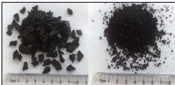
شکل ۳- خرده و پودر لاستیک مورد استفاده
