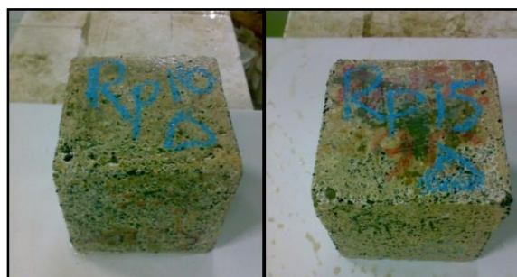
شکل ۱۱- نمایی از نمونه‌های حاوی ۱۵ و ۲۰ درصد پودر لاستیک پس از خوردگی
