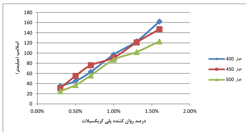
شکل ۱۵- مقایسه تغییرات اسلامپ در برابر درصد روان کننده پلی کربوسیلیات در بتن های با عیار مختلف سیمان
