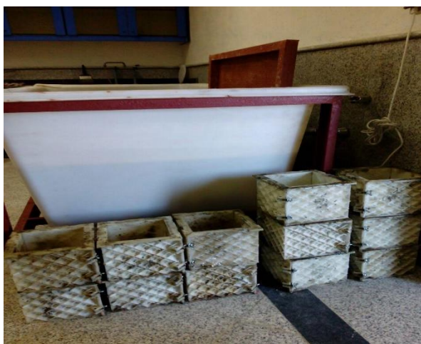
شکل ۴- آماده‌سازی قالب‌ها قبل از قالب‌گیری شدن
