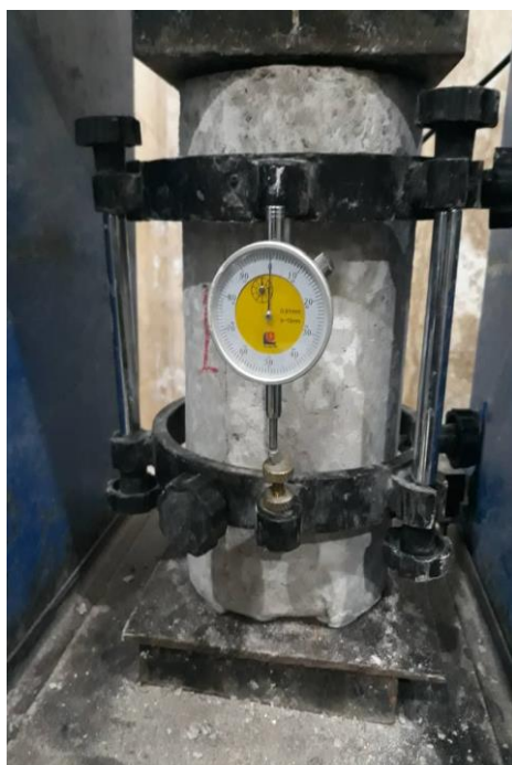
شکل ۶: نمونه تحت آزمایش مدول الاستیسیته
