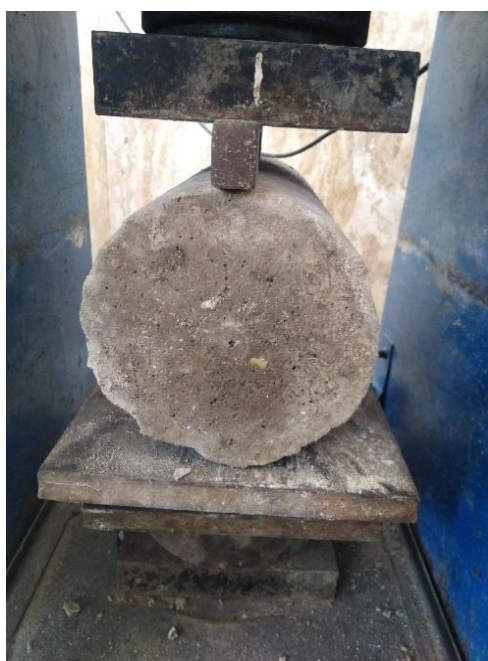
شکل ۴: نمونه بتنی تحت بارگذاری کششی
