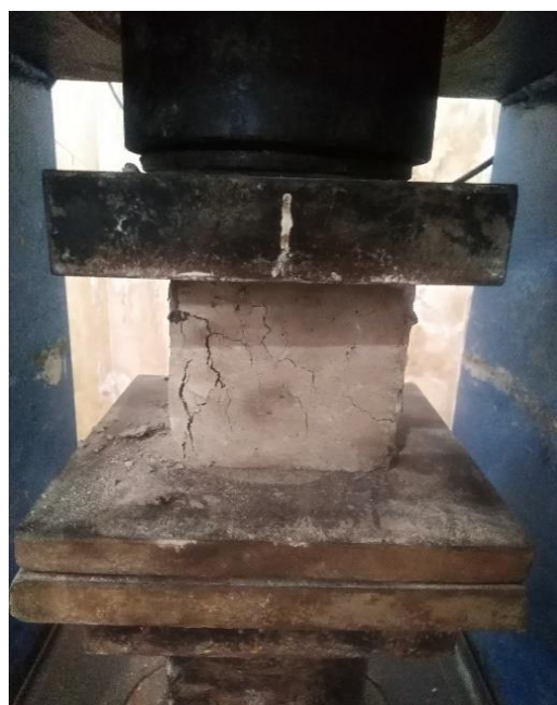
شکل ۲: نمونه تحت بار فشاری توسط دستگاه جک بتن شکن
