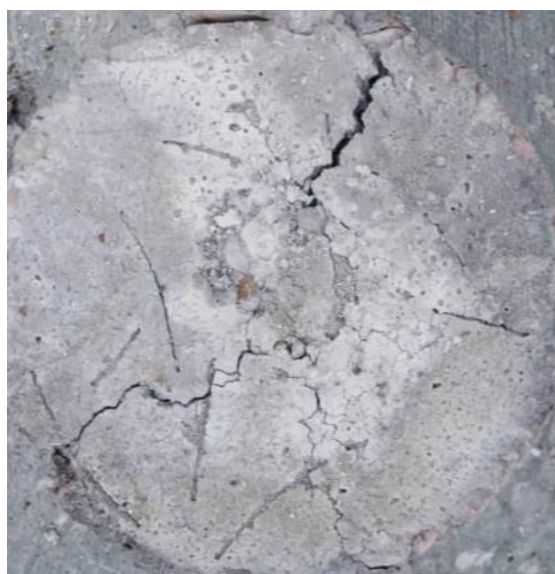
شکل ۱۰: نمونه شکسته شده در اثر ضربه چکش افتان
