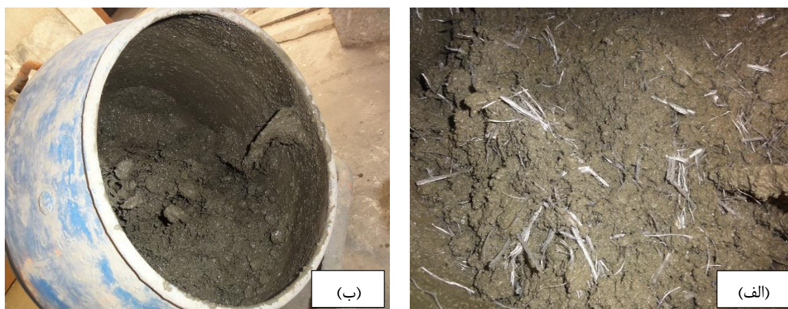
شکل ۲: نمونه‌ای از بتن الیافی با چهار درصد الیاف ماکرو سینتتیک: (الف) الیاف، (ب) مخلوط
