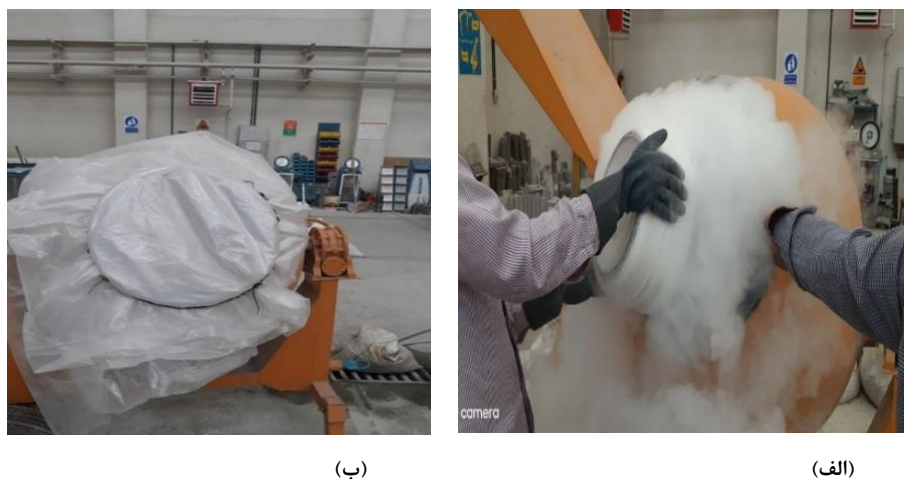
شکل ۳: (الف) تبخیر نیتروژن مایع به هنگام تزریق آن داخل میکسر (ب) جلوگیری از تبخیر نیتروژن با استفاده از کاور.
