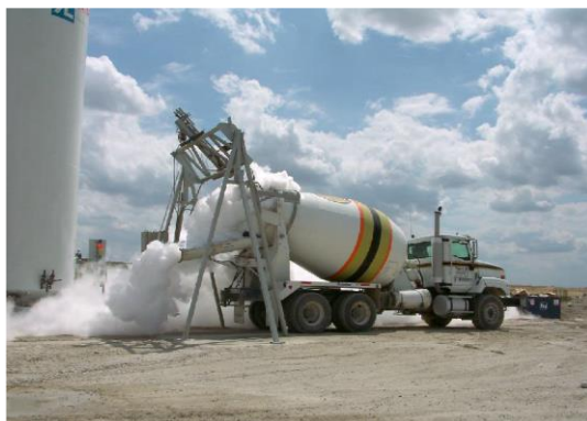
شکل ۱: تزریق مستقیم نیتروژن مایع داخل تراک میکسر [۳].
