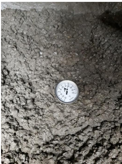
شکل ۲: اندازه‌گیری دمای بتن با استفاده از دماسنج بتن
