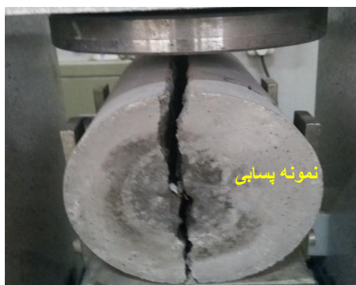
شکل ۱۱: مقایسه شکافت کششی نمونه شاهد و نمونه پسایی
