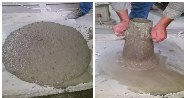
شکل ۵: انجام آزمایش جریان اسلامپ
