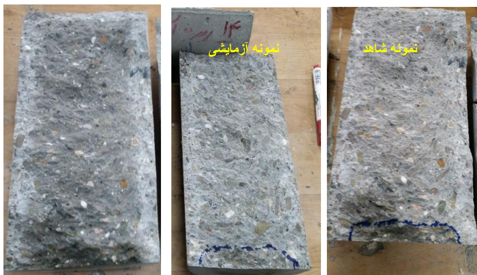
شکل ۱۳: نفوذپذیری آب در نمونه‌های پسابی و نمونه‌های شاهد
