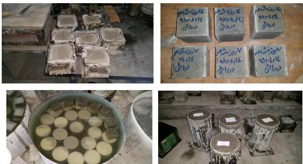
شکل ۴: مراحل قالب‌گیری، باز نمودن قالب و عمل‌آوری نمونه‌ها
