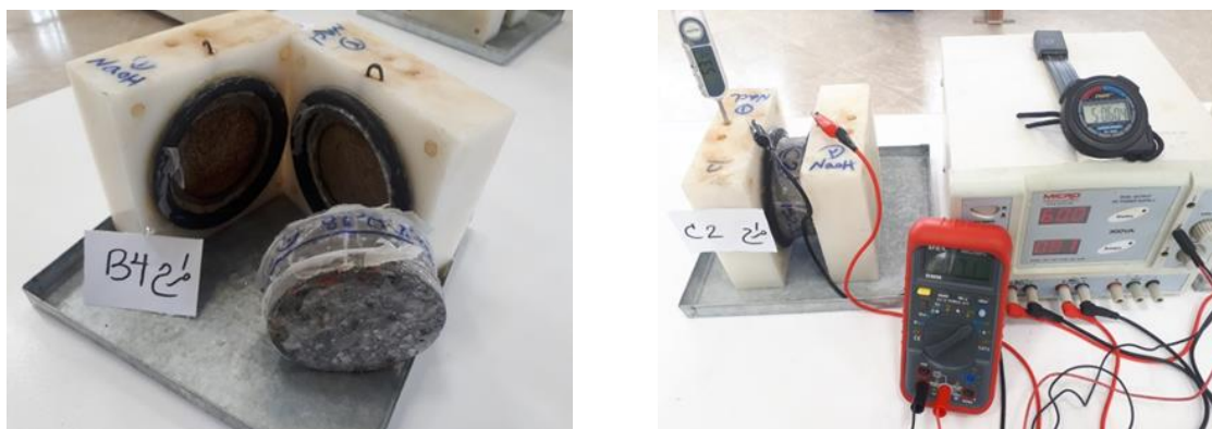
شکل ۳: آزمون RCPT براساس استاندارد ASTM C 1202.
