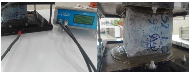
شکل ۴: آزمایش مقاومت ویژه الکتریکی نمونه‌های A و B.
