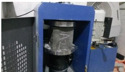
شکل ۵: آزمون مقاومت فشاری نمونه‌ها برابر استاندارد ASTM C109.
