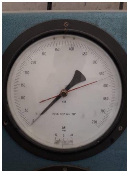
شکل ۳۵: حداکثر نیروی شکست یکی از نمونه‌های آزمایشگاهی تحت بارگذاری
