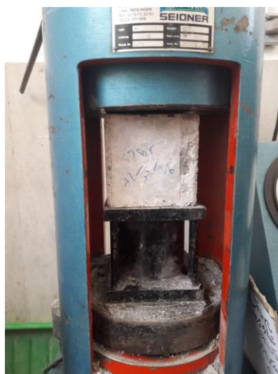
شکل ۳۴: نمونه آزمایشگاهی تحت بارگذاری
