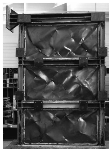
شکل ۴: مدل آزمایشگاهی تحت بار چرخه ای [۳۳]
