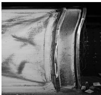
شکل ۶: تغییر شکل برشی در ستون طبقه‌ی اول مدل آزمایشگاهی دیوار برشی فولادی در مطالعه‌ی چوی و پارک [۳۵]
