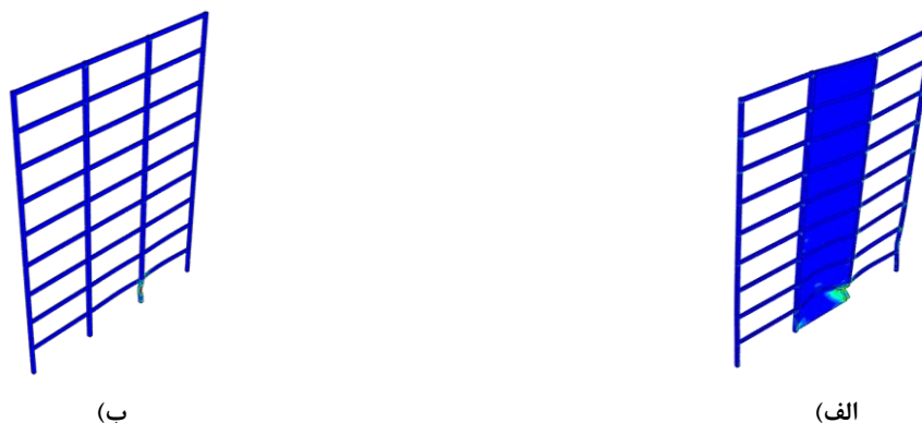
شکل ۲۶: کرنش‌های پلاستیک در قاب‌های مورد مطالعه (الف) دیوار برشی فولادی و (ب) قاب خمشی
