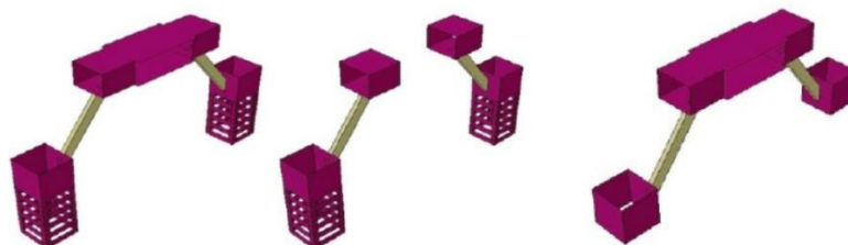
شکل ۲۶- حالت‌های مقاوم‌سازی ستون و تیر در صورت نیاز به تقویت [۱۸]
