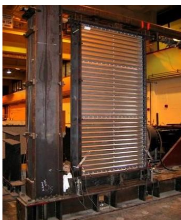
شکل ۱: مطالعه آزمایشگاهی دیوار برشی فولادی سرد نورد شده [۱۶].
