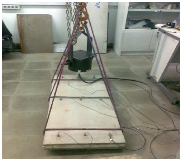
شکل ۳: دیوار پانلی پیش ساخته با شرایط تکیه گاهی آزاد [۳۰]
